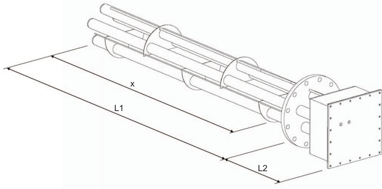
In der Klimatechnik werden Elektrolufterhitzer für die Vorwärmung der Luft in der chemischen und der pharmazeutischen Industrie eingesetzt. Prozesstemperaturen werden in der Verfahrenstechnik benötigt, wenn bei Druckmaschinen Papierbahnen getrocknet, Tanks und Container nach der Reinigung mit Heissluft getrocknet oder Reaktionen mit erhitzten Gasströmen gestartet werden.
