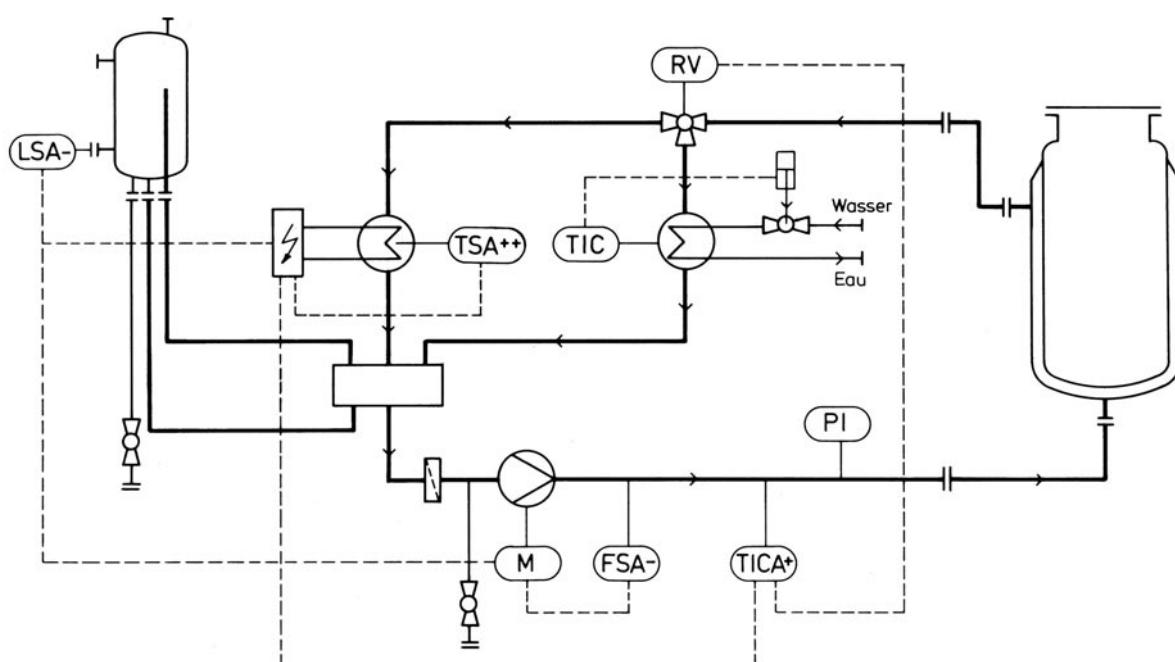
Wärmeübertragungseinheit mit in Reihe geschalteter Heizung und Kühlung
