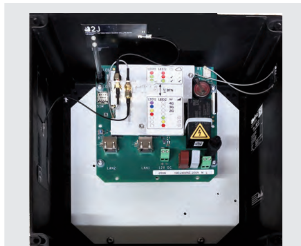
Gateway Model 2 12 V DC 100 – 240 V AC, 50/60 Hz max. 20 VA -20°C ≤ T amb ≤ 50°C
