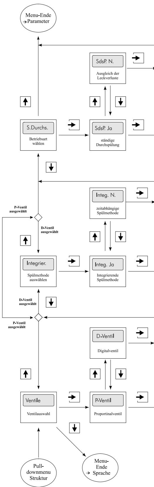
Abbildung 7: Flussdiagramm, Parametermenü
