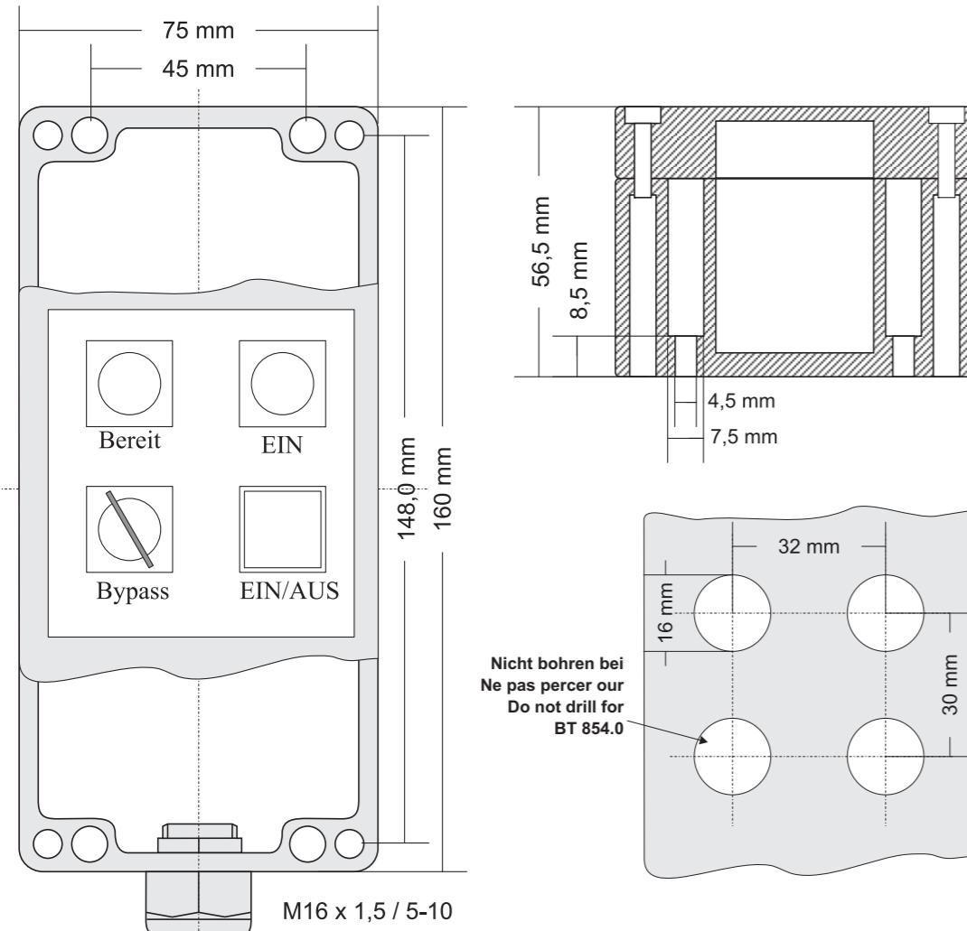
Abbildung 14: Digitalventil
