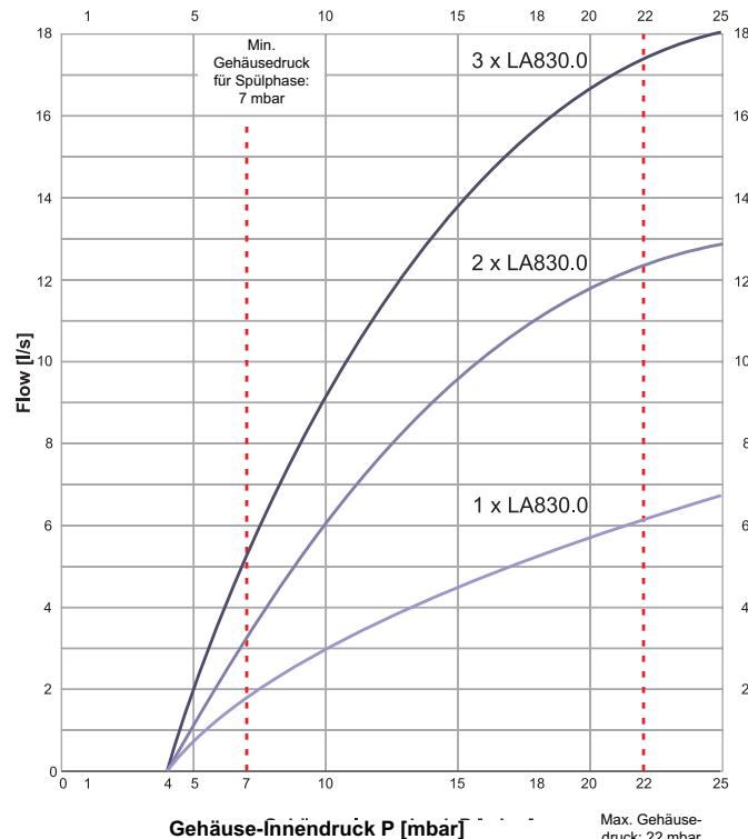
Das Durchflussdiagramm gibt Richtwerte für die Durchflussrate bei dem zugehörigen Druck im Gehäuse an. Die Kurve ist nur gültig, wenn keine reduzierten Einlass- und Auslassquerschnitte sowie reduzierende Verrohrungen die Durchflussrate senken.
