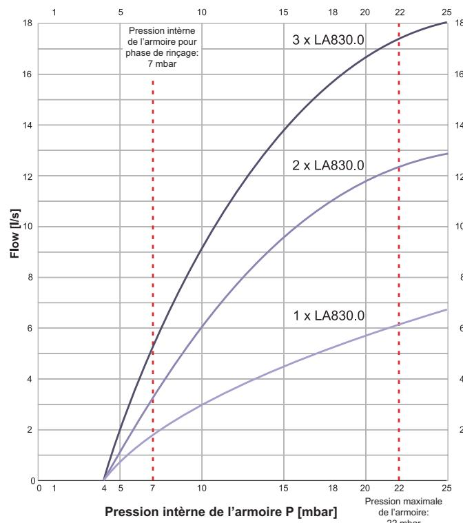
Ce diagramme montre la relation entre la pression à l'intérieur de l'armoire et le débit. Ce diagramme est valable uniquement si aucune restriction n'est posée sur l'entrée, la sortie ou les tubes.
