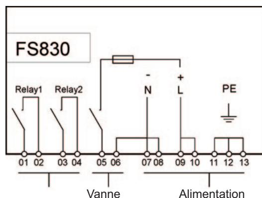
contacts pour enclenchement hors tension; alarme
